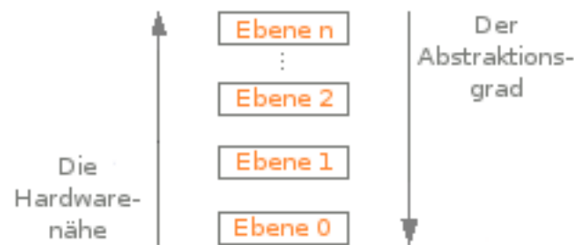
Abbildung 3.1: Die Hierarchie des CSBP: Der Abstraktionsgrad steigt während die Hardwareabhängigkeit sinkt.
