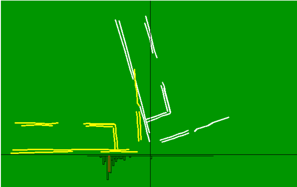
Abbildung 4.2: Gerade Feldlinien relativ zum Roboter gesehen sind in Weiß gezeichnet. In Schwarz ist das Orientierungshistogramm dargestellt, der rote Block gibt die gemittelte Orientierung in der Nachbarschaft von \pm 10^\circ an. Hier ergibt sich z.B. ein Wert von 15^\circ , d.h. der Roboter ist um -15^\circ gedreht (oder 90 - 15 = 75^\circ , 180 - 15 = 165^\circ usw.). Die gelben Feldlinien spiegeln die um 75^\circ rotierten Feldlinien wieder, die nun nur senkrecht und waagrecht verlaufen.
